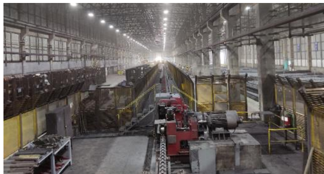
Слика 45 Ладилна кутија и внатрешен резервоар за собирање вода од ладилната кутија
