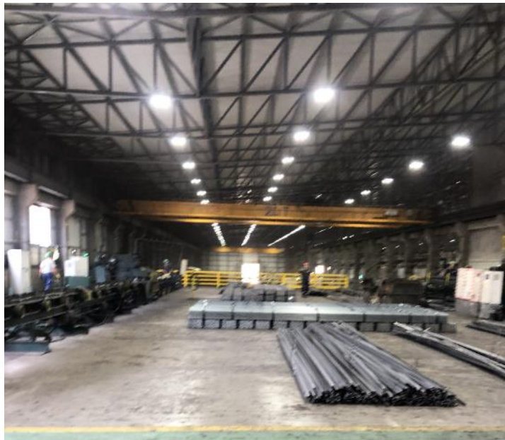
Слика 3 Дел од погонот (горен кат) каде се врши исправување на криви профили
