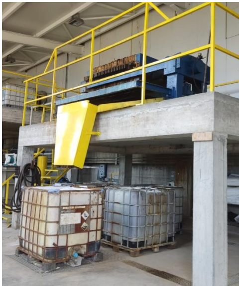
Слика 70 Филтер преса (горе) и канистер за собирање на отпадна вода (долу)
