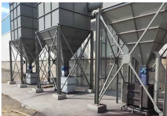
Слика 48 Садови и џамбо вреќи за прифаќање на отпадна прашина од филтри
