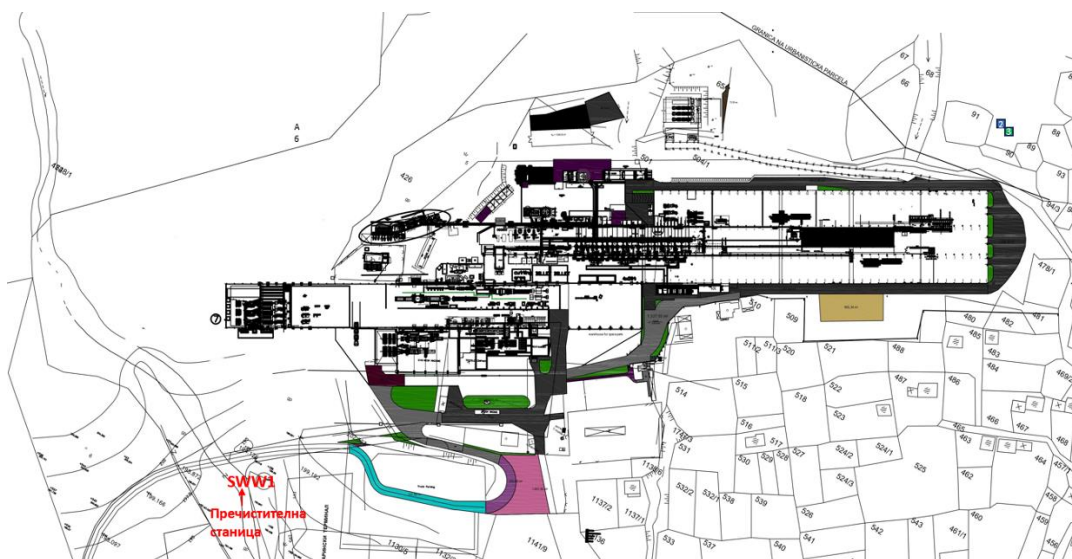
Слика 5 Испуст на третирани санитарни води од пречистителна станица во земјен канал и од таму во суводолица
