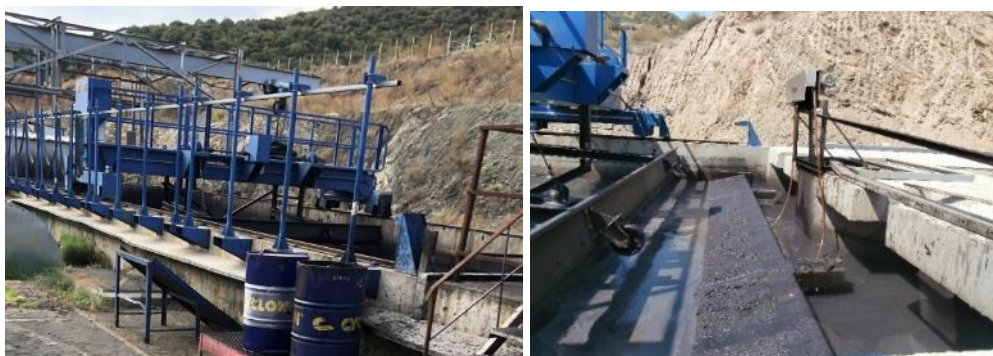
Слика 3 Базен за фино таложење и отстранување на масла
