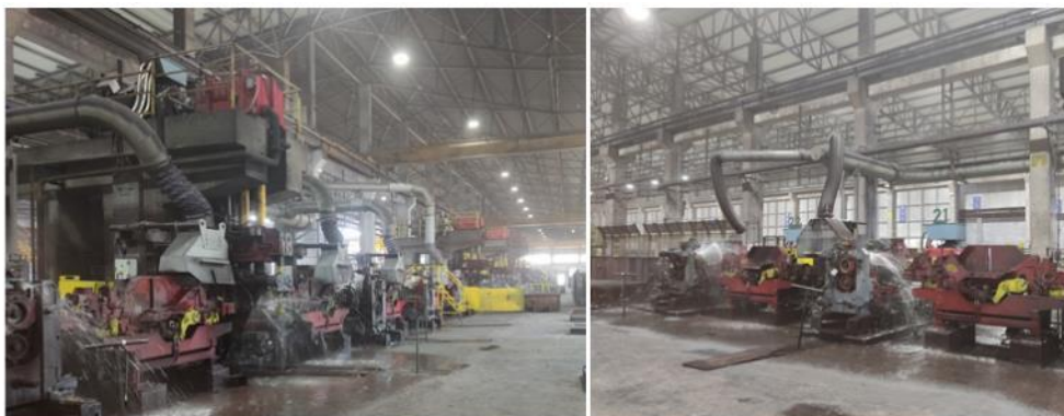
Аспиратори за всисување и канали/цевки за прифаќање на отпадни гасови од производна линија во погон Валавница
